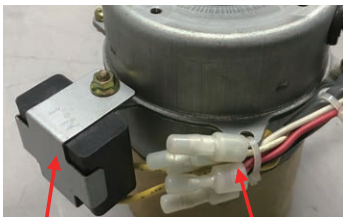
コンデンサ 内部配線接続部
