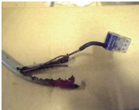
▲薬剤の影響による腐食、焦げ、樹脂割れ
