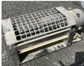
▲洪水、浸水による換気扇被水
