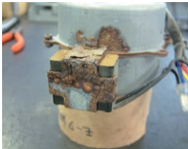
▲塩害の影響による腐食、断線（焦げ）
