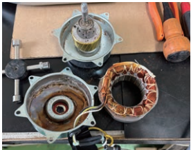
▲洪水、浸水による換気扇被水
