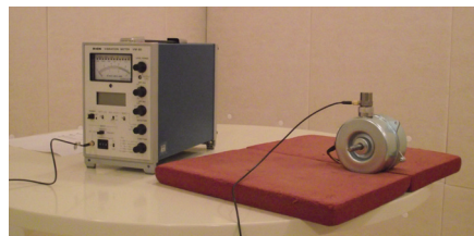
■振動計を用いたモーターの振動測定。
