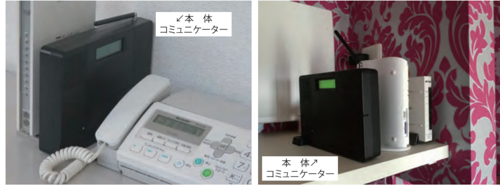
■設置例1：一般電話機の近くに設置した事例 ■設置例2：光電話機器の近くに設置した事例 ※一般電話機が接続してある回線はどの回線でも使用できます。 ※ビジネス回線は使用できません (一般電話機が接続可能なFAX複合機は使用可能)
