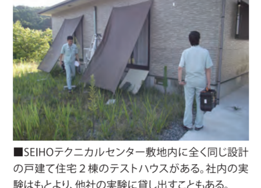
■SEIHOテクニカルセンター敷地内に全く同じ設計の戸建て住宅2棟のテストハウスがある。社内の実験はもとより、他社の実験に貸し出すこともある。
