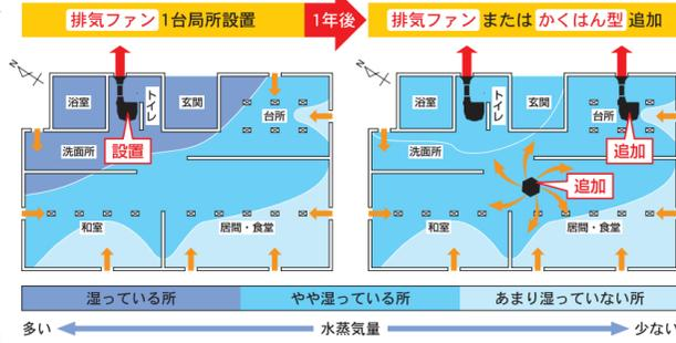
その後の定期点検を通じて床下の状況いかによっては排気型や攪拌・拡散型追加の提案を実施してください。
