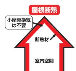
「長期優良住宅」では、天井に断熱材を設ける「天井断熱」の小屋裏には、構造躯体の劣化対策として、認定基準に定めた小屋裏換気措置(換気孔)が必要となります。小屋裏の通気をよくして、熱気・湿気等を取り除くために換気孔を設けることとなりますが、実際の住宅では複雑な屋根形状や住宅自体の立地条件等で、熱気・湿気を取り除くために必要な換気が出来ていない場合もあります。そこで、安定した換気を確保できる機械換気を提案します。
