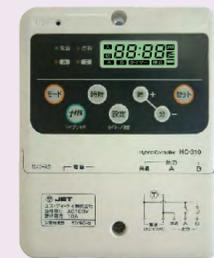
ハイブリッドコントローラーでは、**絶対湿度（水蒸気量）をセンサーによって感知・判別し換気運転を制御**しますので水蒸気量が多いときには換気運転をストップさせます。しかしその場合も床下の空気そのものが長期停滞することがないように攪拌・拡散送風機のみタイマー制御で運転をさせます。これはカビや腐朽菌の繁殖の抑制にもなります。また、例えば冬場などは相対湿度80%であっても気温が低いため水蒸気量が少なくなっていますので換気運転を行います。
