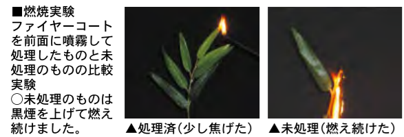
●燃焼実験 ファイヤーコートを前面に噴霧して処理したものと未処理のものとの比較実験 ○未処理のものは黒煙を上げて燃え続けました。 ▲処理済(少し焦げた) ▲未処理(燃え続けた)
