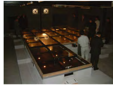
▲シミュレーションスタジオ視察風景。換気扇の効果がスモークの流れで確認できます。とくに排気や拡散の静圧力をご覧ください。
