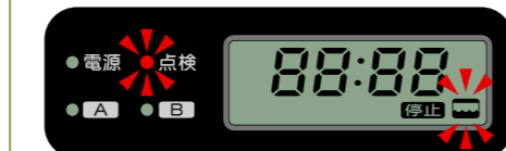
■ハイブリッド・コントローラーの点検ランプが点滅し、異常をお知らせします。
