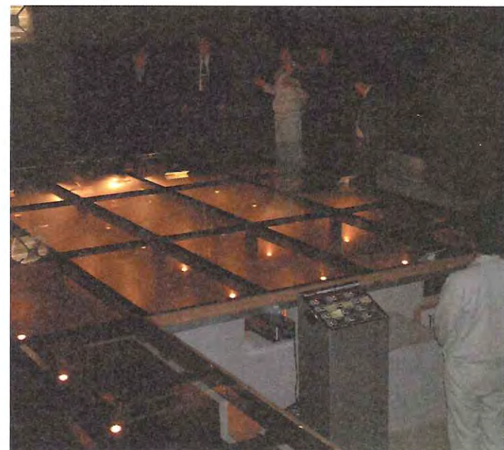
●シミュレーションスタジオにおける床下換気の実験
