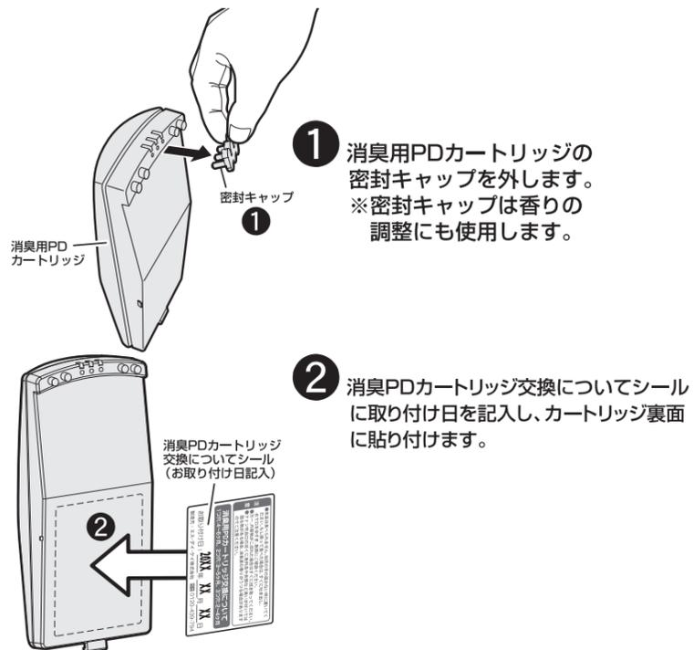
※消臭用PDカートリッジの交換の際は右図を参照してください。
