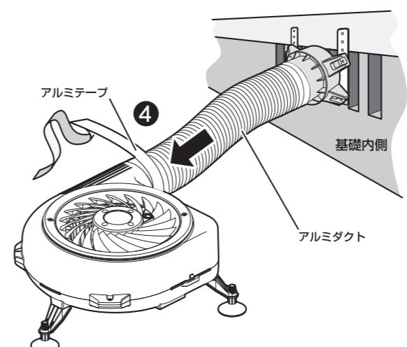
③ 吹出ノズルのアルミダクト挿入口にアルミダクトを差し込み、アルミテープで締め付け、固定します。
