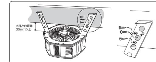
※取付板のツメ部を引っ掛け可能な木部の大きさは、□105mmまでです。それ以上大きな場合はツメ部を引っ掛けず、反対側より取付けてください。その際、取付木材から吸込口までは必ず35mm以上はなしてください。
