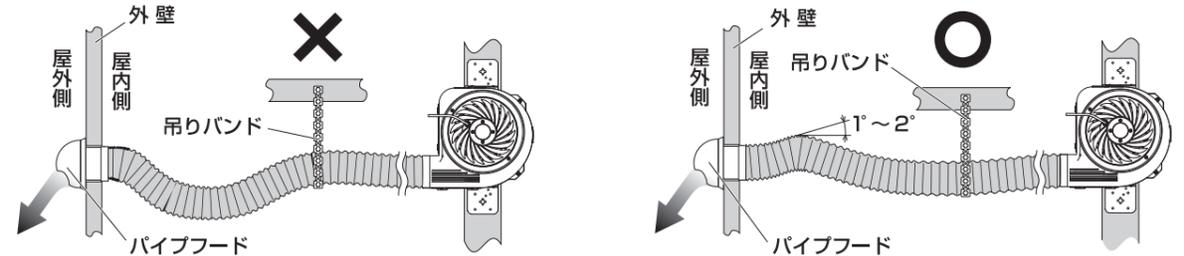
**結露対策について** ●冬期など周囲とダクトの温度差のため、ダクトが結露する際は(特に寒冷地)、ダクトに断熱材を巻くか、断熱対策がなされているダクト(市販品)の使用をおすすめします。
