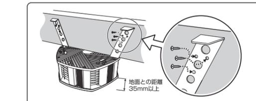
※取付板のツメ部を引っ掛け可能な木部の大きさは、□140mmまでです。それ以上大きな場合はツメ部を引っ掛けず、反対側より取付けてください。その際、床面から吸込口までは必ず35mm以上はなしてください。
