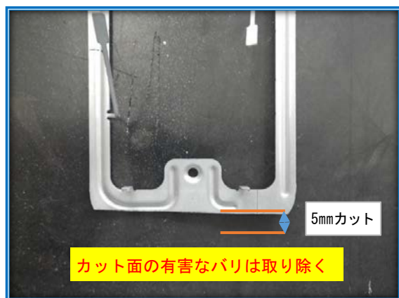
②押え金具の下部を5mmカットする。 (金具品番：パナ電工 WN39960)
